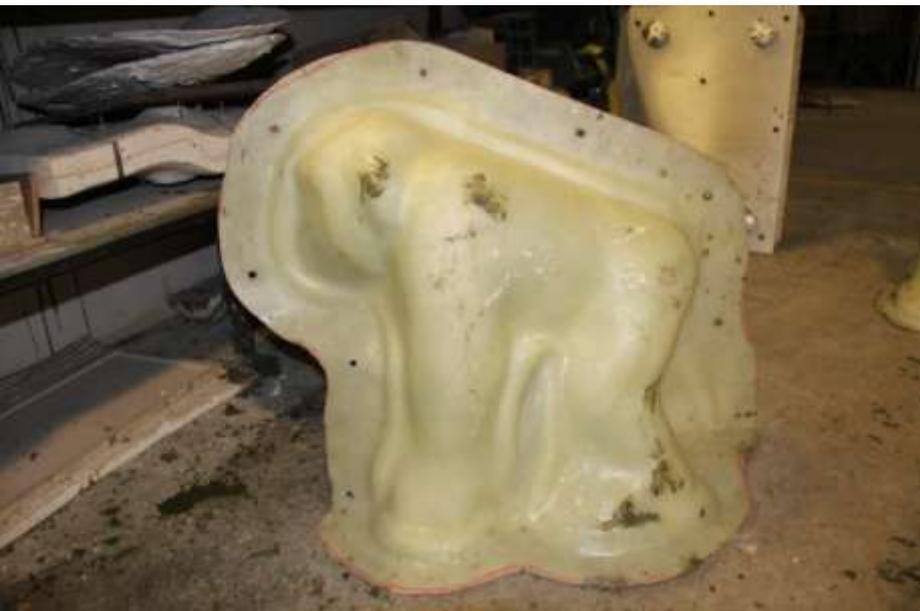
El molde consta de cuatro piezas diferenciadas; dos para la pata delantera derecha y dos para los dos lados del cuerpo del cuerpo.
