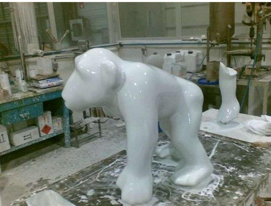
El modelo es recubierto con varias capas de silicona para la obtención del molde.
