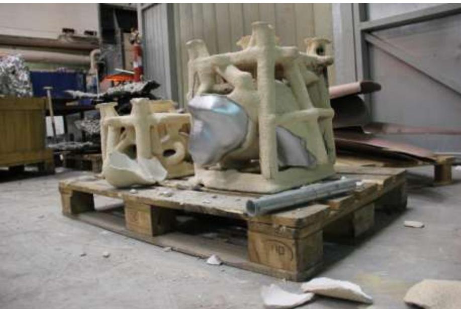
Una vez frío el metal se procede al desmoldeo rompiendo la cerámica y dejando al descubierto el metal con los bebederos, etc. Que serán cortados posteriormente en el proceso final de la pieza.
