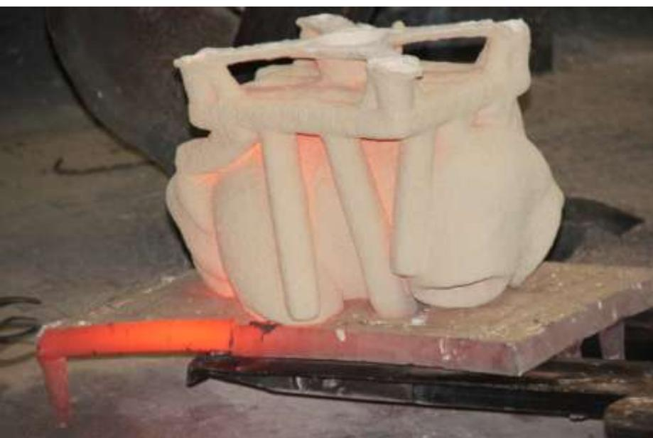
El molde cerámico se introduce en un lecho de arena para soportar las tensiones al rellenarse con el metal fundido.
