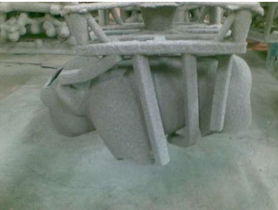
Obtenidas las ceras de las diversas partes de la pieza, esta se recubre con materiales cerámicos en un proceso en el que se aplica una capa diaria durante 10 días además de un sellado final.
