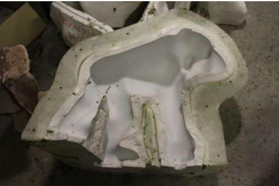
El molde se refuerza con piezas de fibra de vidrio para dar rigidez a la silicona y facilitar el desmoldeo de las ceras.
