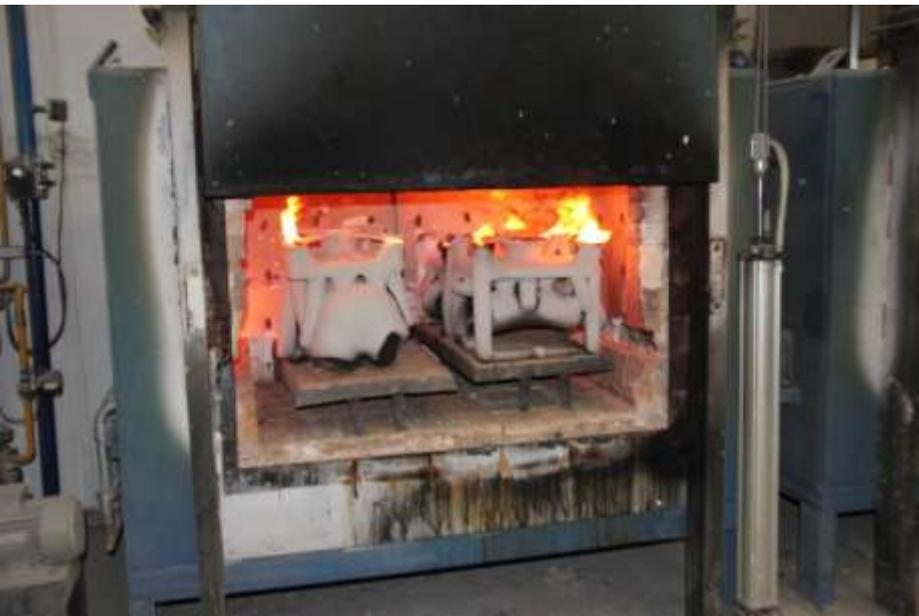
El molde es introducido en un horno en el que alcanza la temperatura adecuada para recibir el metal fundido.
