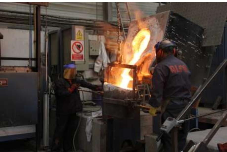
El bronce es fundido en un horno de inducción. El material fundido se traslada a la zona de vertido en una "cuchara" soportada por un sistema "ingrávido" por los operarios. El bronce es vertido a una temperatura de 1200°C en el interior del molde.
