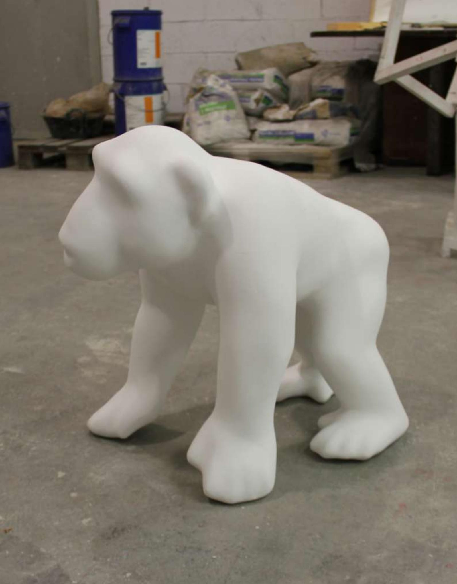
Tras la preparación final del modelo de poliestireno expandido con escayola, para lograr el acabado superficial que se transferirá a la pieza, se inicia el proceso de fabricación del molde de silicona en los que se obtendrán los modelos en cera que se utilizarán para la “fundición a la cera perdida”.
