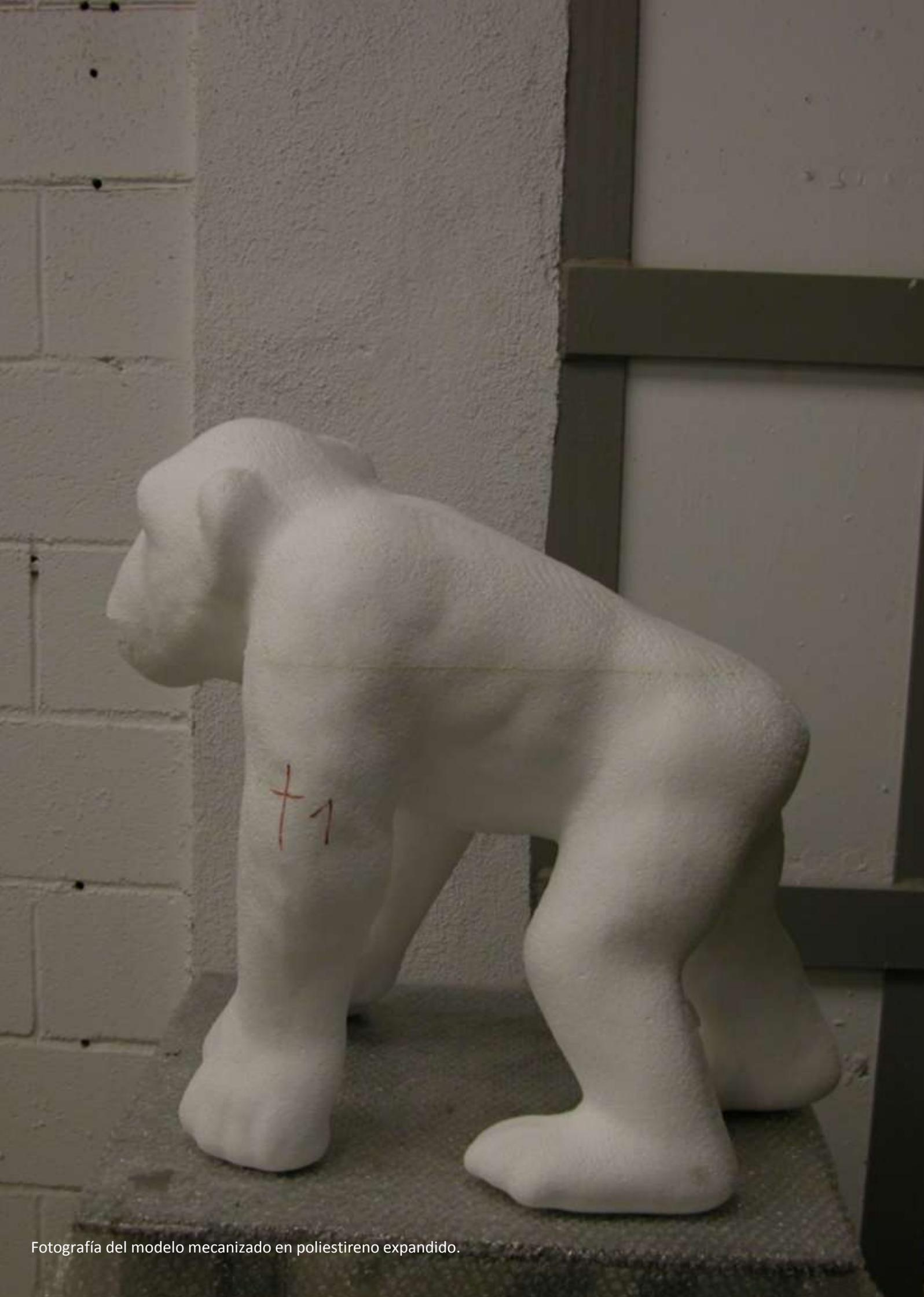
Fotografía del modelo mecanizado en poliestireno expandido.
