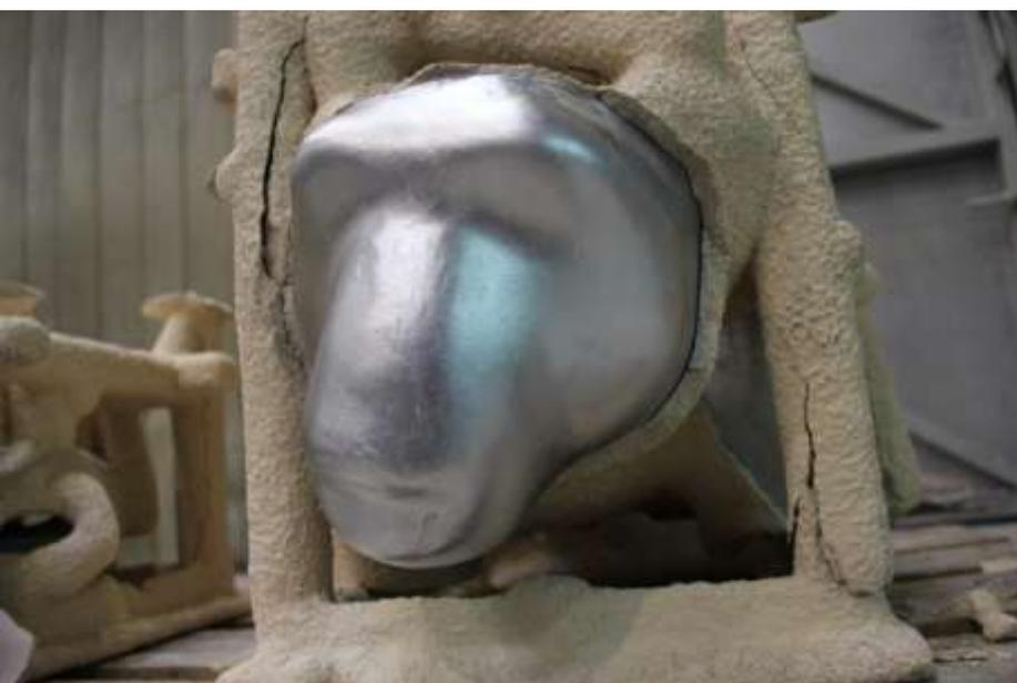
En la imagen podemos observar el acabado de la pieza antes de su preparación para la pintura.
